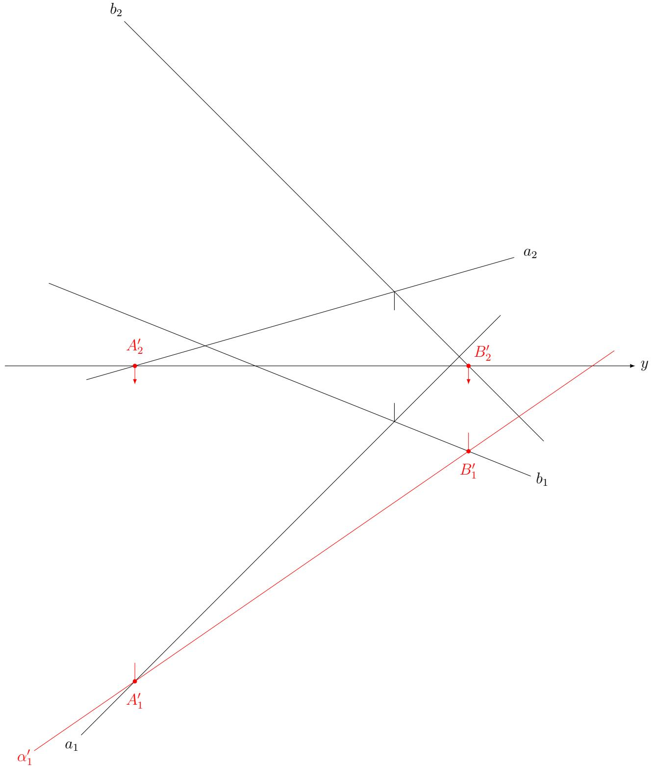
La deuxième trace de  $\alpha$  passe par  $A''$  et par le point  $I$ , point d'intersection de  $\alpha'$  avec la ligne de terre.
