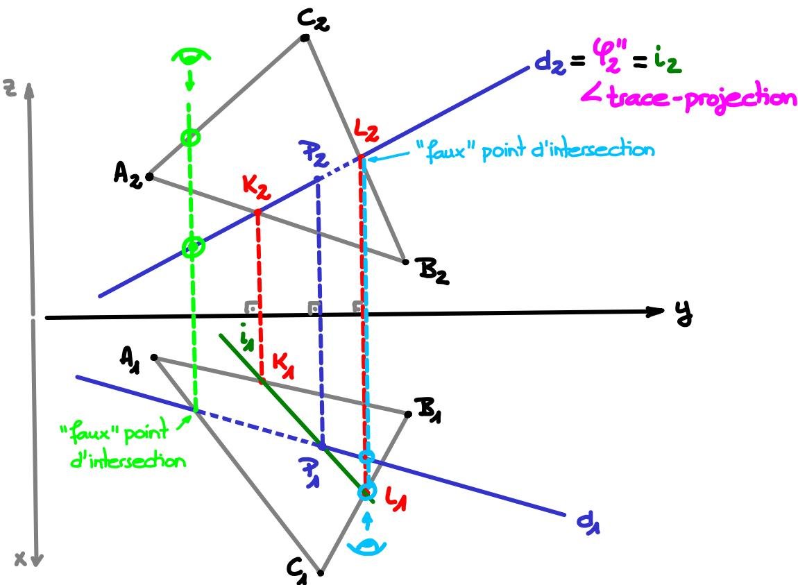
On utilise le 2<sup>ème</sup> projectant  $\Phi$  de la droite  $d$  comme plan auxiliaire.
