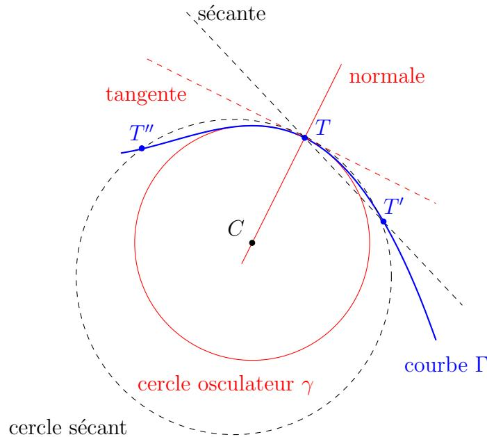
Tout comme la tangente à  $\Gamma$  en  $T$  passe par « deux points de  $\Gamma$  infiniment proches » (cas limite de la sécante par  $T$  et  $T'$ ), le cercle osculateur passe par « trois points de  $\Gamma$  infiniment proches » (cas limite de cercle sécant par  $T''$ ,  $T$  et  $T'$ ).
