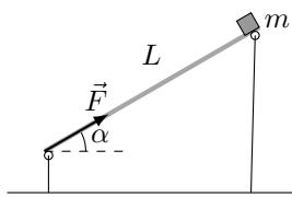
Une planche homogène de masse  $M$  et de longueur  $L$  repose sur deux petites roulettes situées sous les extrémités de la planche, mais à des hauteurs différentes, de sorte que la planche fait un angle  $\alpha$  avec l'horizontale. De plus, une masse  $m = M/2$  est immobile tout en haut de la planche. On note  $\vec{F}$  la force appliquée au bas de la planche, parallèle à celle-ci, qui est nécessaire au maintien de l'équilibre.
