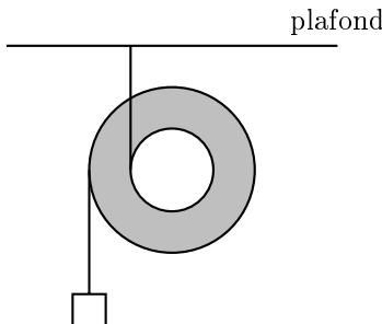
Un disque homogène de rayon  $R = 2r$  est percé en son centre d'un cylindre creux de rayon  $r$ , le tout ayant une masse  $M = 2m$  et un moment d'inertie  $I_0 = \lambda mr^2$  par rapport à son axe de symétrie. Un fil fixé à un plafond est enroulé sur le cylindre. Un second fil est enroulé sur le disque et attaché à une masse  $m$ .
