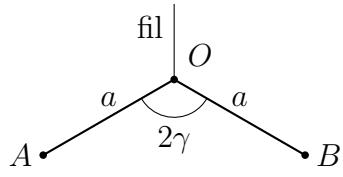
Une balance est formée de deux tiges de longueur  $a$ , de masse négligeable, formant un angle  $2\gamma$ . Sur les extrémités libres  $A$  et  $B$  sont montées des masses  $m$  et  $M$  respectivement. On suspend la balance par le point  $O$  commun aux deux tiges. Donner l'angle que fait, à l'équilibre, la normale à  $AB$  avec la verticale.
