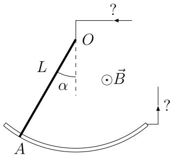
On propose le dispositif ci-contre pour mesurer l'intensité d'un courant. Une tige métallique de masse  $m$  et de longueur  $L$  peut pivoter autour d'un axe horizontal passant par l'une de ses extrémités  $O$ . L'autre extrémité  $A$  peut alors glisser sans frottement sur un conducteur fixe. Le tout est plongé dans un champ magnétique  $\vec{B}$  uniforme et parallèle à l'axe de rotation.
