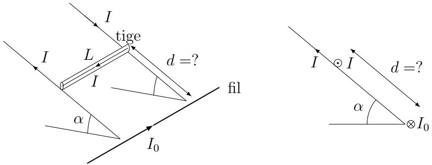
Deux rails conducteurs parallèles séparés d'une distance  $L$  forment un angle  $\alpha$  avec le sol. A leur extrémité inférieure est placé un fil traversé par un courant  $I_0$  connu. La tige de longueur  $L$  et de masse  $m$  est posée sur les rails, parallèlement au fil. Elle peut glisser sans frottement le long des rails.
