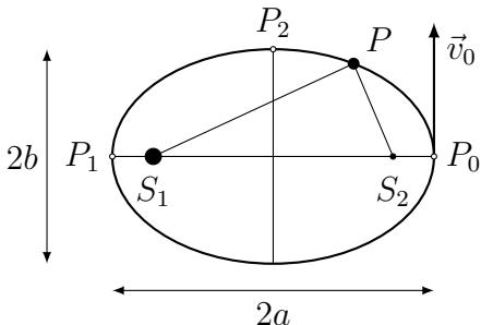
Une planète (point  $P$ ) décrit autour d'un astre (point  $S_1$ ) une trajectoire elliptique de demi-axes  $a$  et  $b$ . Les points  $S_1$  et  $S_2$  sont les foyers de l'ellipse définie par la contrainte  $\overline{S_1P} + \overline{S_2P} = 2a$ .
