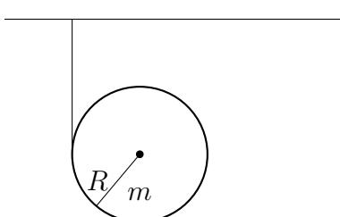
Un fil fixé à une poutre est enroulé autour d'un cylindre plein et homogène, de rayon  $R$  et de masse  $m$ . Départ arrêté, on laisse aller le cylindre. Calculer l'accélération et l'accélération angulaire du cylindre.
