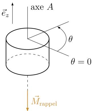
Un objet est suspendu à un fil autour duquel il peut osciller. Sa position est repérée par un angle  $\theta$ . Au repos,  $\theta = 0$ . Hors équilibre, le fil exerce sur l'objet un couple de rappel par rapport à l'axe du fil  $\vec{M}_{\text{rappel}} = -C\theta\vec{e}_z$  (pendule de torsion).  $C$  est la constante de rappel du fil.
