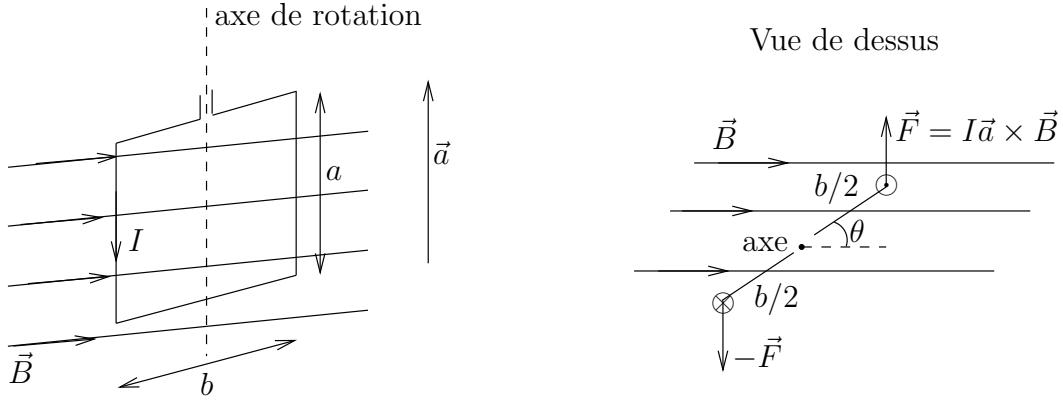
Lorsque le couple est compensé par un couple de rappel de constante  $C$ , la mesure de l'angle d'équilibre  $\theta$  permet de déduire le courant traversant le cadre :
