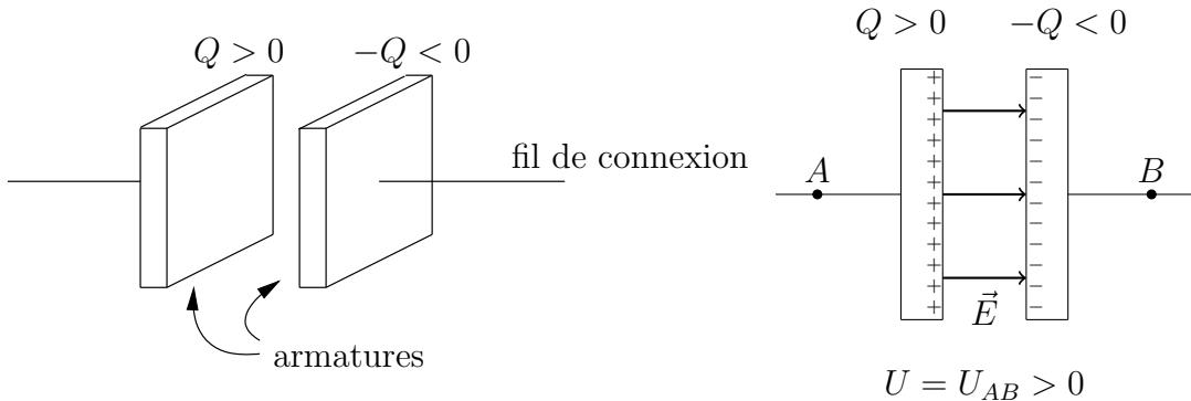
Dans un condensateur, i) on crée un champ  $\vec{E}$ , ii) on stocke des charges.
