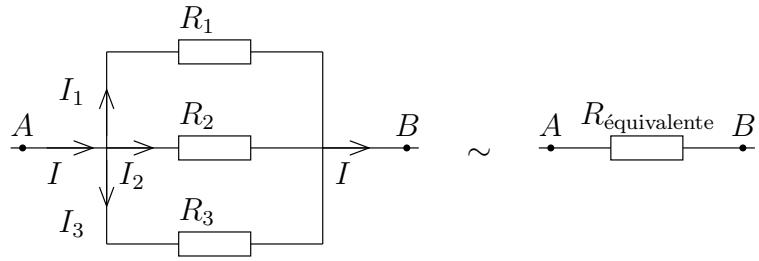
$$\frac{1}{R_{\text{équivalente}}} = \frac{1}{R_1} + \frac{1}{R_2} + \frac{1}{R_3}.$$
