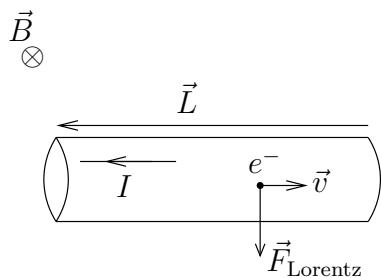
Les électrons de conduction subissent  $\vec{F}_{\text{Lorentz}}$  et appuient sur le fil. Ainsi, un fil parcouru par un courant dans un champ magnétique subit la **force de Laplace**
