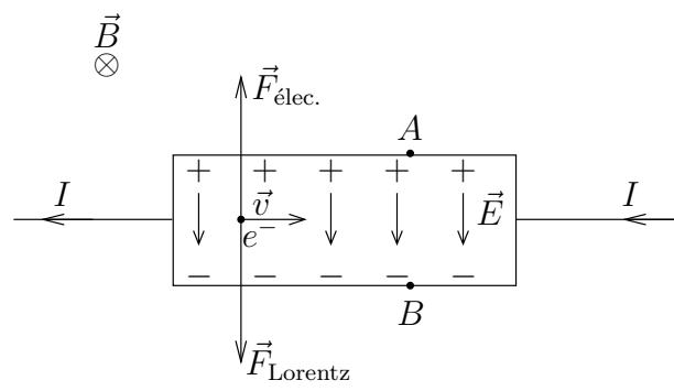
Sous l'effet de  $\vec{F}_{\text{Lorentz}}$ , les charges se séparent jusqu'à ce que  $\vec{F}_{\text{elec.}}$  (due au champ électrique créé par les charges déplacées) compense exactement la force magnétique :
