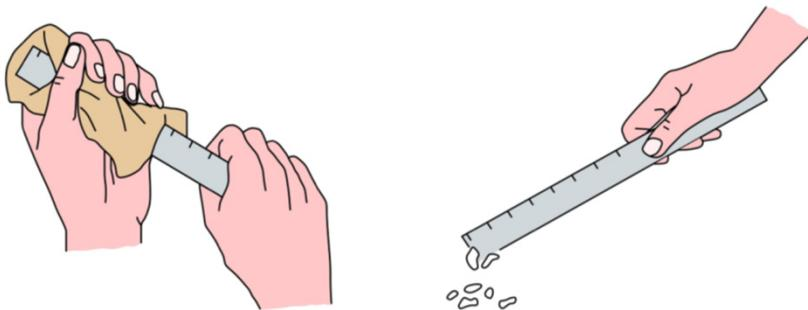
On charge une baguette à l'aide d'un chiffon. De petits morceaux de papier sont attirés dû à la force électrique exercée par les charges de signe opposé présentes sur la baguette.
