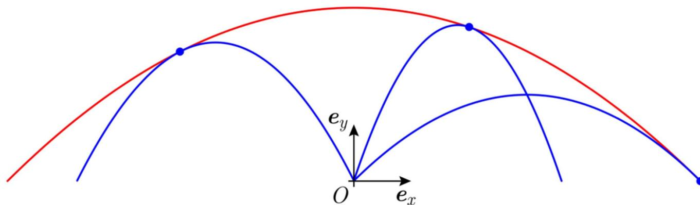
Différentes trajectoires paraboliques en bleu et parabole de sûreté en rouge.
