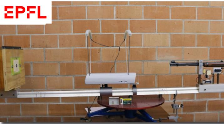
La vitesse de la balle de fusil est mesurée à l'aide de deux cellules photoélectriques.
