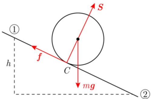
Une roue initialement au repos roule sans glisser sur un plan incliné. Que vaut la vitesse de la roue après une descente d'une hauteur  $h$ ?
