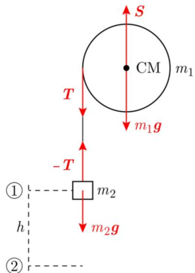
Une poulie est entraînée par une masse initialement au repos. Quelle est la vitesse  $v$  de la masse après une chute d'une hauteur  $h$ ?
