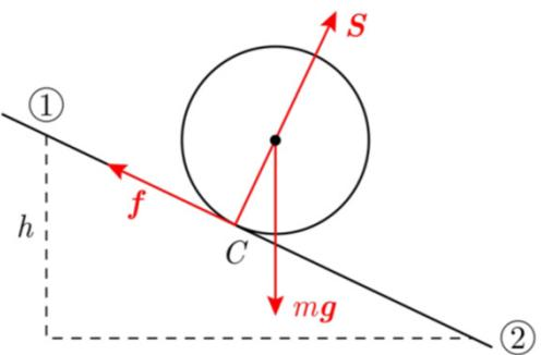
Une roue initialement au repos roule sans glisser sur un plan incliné. Que vaut la vitesse de la roue après une descente d'une hauteur  $h$ ?
