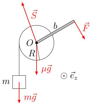
Forces : poids du cylindre, poids du seau, soutien sur l'axe  $O$ , force en bout de tige.
