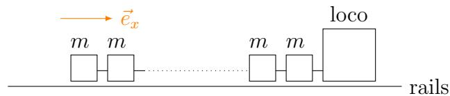
En l'absence de frottement, le dernier wagon (objet considéré) subit son poids, la force de réaction des rails (soutien) et la force de norme  $F$  exercée par l'avant-dernier wagon. Les deux premières forces sont verticales et se compensent. La troisième force est horizontale, et la deuxième loi de Newton, appliquée au dernier wagon et projetée selon  $\vec{e}_x$  vers l'avant, s'écrit
