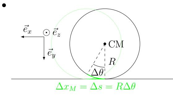
Si, pendant  $\Delta t$ , le cylindre tourne d'un angle  $\Delta\theta$  dans le sens donné par  $\vec{e}_z$ , il "enroule" sur le sol une longueur
