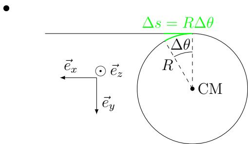
Si, pendant  $\Delta t$ , le cylindre tourne d'un angle  $\Delta\theta$  dans le sens donné par  $\vec{e}_z$ , le fil se déroule et le contrepoids se déplace de  $\Delta s = R\Delta\theta$  par rapport au cylindre dans le sens donné par  $\vec{e}_y$ . Comme le cylindre avance de  $\Delta x_M$ ,  $m$  se déplace de
