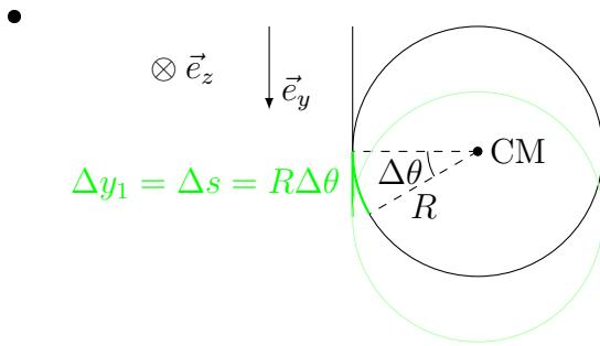
Si, pendant  $\Delta t$ , le cylindre tourne d'un angle  $\Delta\theta$  dans le sens donné par  $\vec{e}_z$ , le fil à gauche se déroule de
