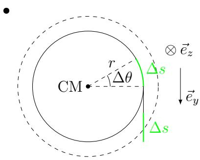
Si, pendant  $\Delta t$ , le cylindre tourne d'un angle  $\Delta\theta$  dans le sens donné par  $\vec{e}_z$ , le fil se déroule et le contrepoids se déplace de  $\Delta s = r\Delta\theta$  **par rapport au cylindre** dans le sens donné par  $\vec{e}_y$ .
