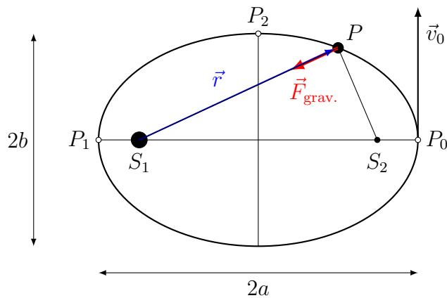
La force de gravitation  $\vec{F}_{\text{grav.}}$  est une force centrale : elle est toujours dirigée vers le même point  $S_1$ . En choisissant comme origine le point  $S_1$ , les vecteurs position  $\vec{r}$  et force  $\vec{F}_{\text{grav.}}$  sont en tout temps parallèles.
