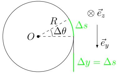
Si la poulie tourne d'un angle  $\Delta\theta$  dans le sens donné par  $\vec{e}_z$ , le fil se déroule et le contrepoids se déplace de  $\Delta y = R\Delta\theta$  dans le sens donné par  $\vec{e}_y$ .
