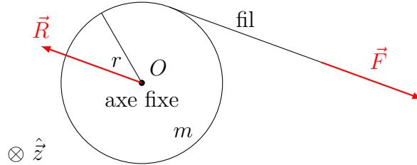
On suppose qu'il n'y a pas de frottement. Le CM du cerceau ne se déplace pas et la somme des forces exercées sur le cerceau est donc nulle : le poids du cerceau (de masse  $m$  et de rayon  $r$ ) est compensé par une force de soutien au niveau de l'axe et  $\vec{F}$  par un second soutien  $\vec{R}$  horizontal.
