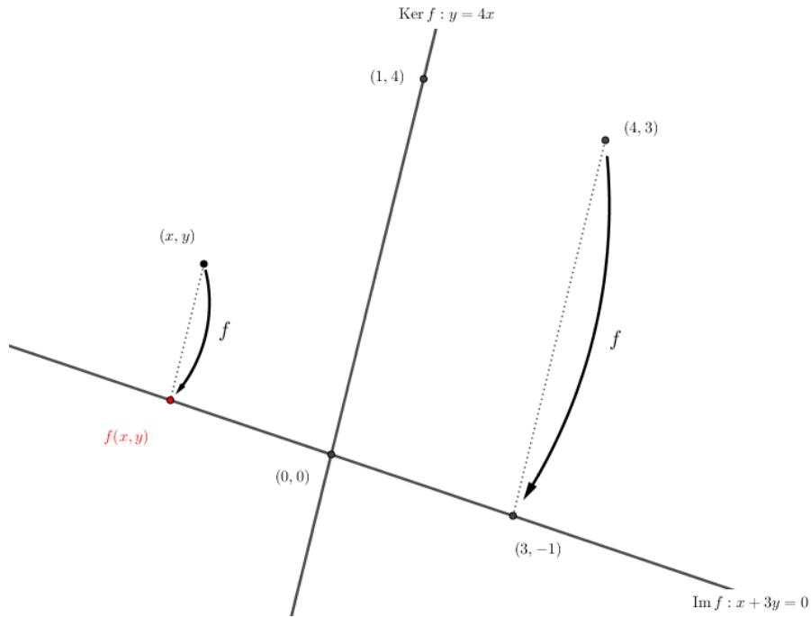
Une fois les droites vectorielles  $\text{Im } f$  et  $\text{Ker } f$  placées sur le dessin, il n'y a plus qu'à projeter  $(x, y)$  sur  $\text{Im } f$  en se déplaçant parallèlement à  $\text{Ker } f$  pour faire apparaître  $f(x, y)$ .
