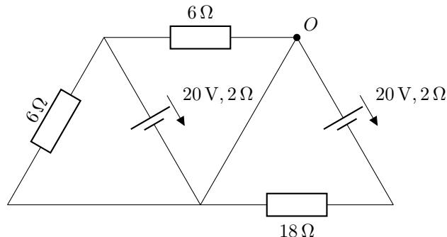
Déterminer le courant dans chaque branche du circuit. Calculer le potentiel des bornes de chaque source de courant en attribuant au point  $O$  le potentiel zéro. (Monard, électricité, ex. 12-5 c, p. 254)
