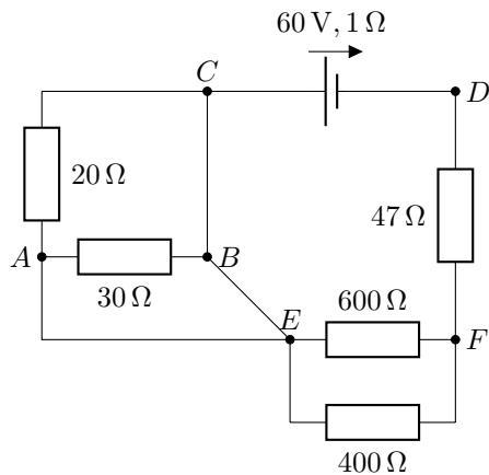
Le court-circuit  $B-E$  ne comportant pas de résistance, tout le courant y circule. Les branches comportant  $R_{20}$  et  $R_{30}$  sont "mortes".
