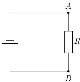
Selon l'énoncé, lorsque le radiateur est branché sur une tension  $U = U_{AB} = 220\text{ V}$ , il dissipe une puissance  $P = 1200\text{ W}$ . Cette puissance a pour expression
