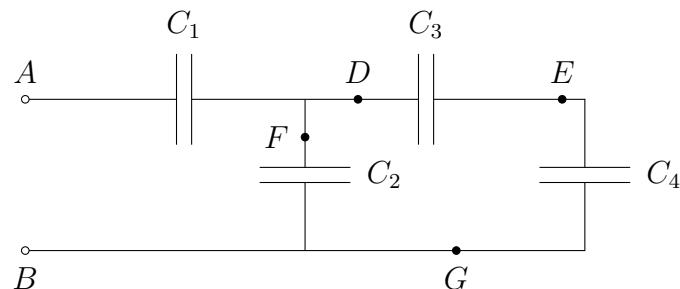
Que valent les potentiels aux points  $D$ ,  $E$ ,  $F$  et  $G$  par rapport à  $A$  si la tension entre  $A$  et  $B$  est  $U_{AB} = 10 \text{ V}$  et quelles sont les charges portées par chacun des condensateurs ?
