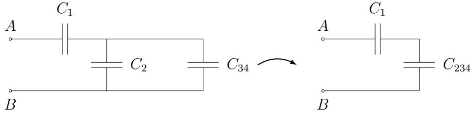
Les condensateurs  $C_1$  et  $C_{234}$  sont en série. On peut donc les remplacer par un condensateur  $C_{1234}$  dont la capacité (équivalente) s'écrit
