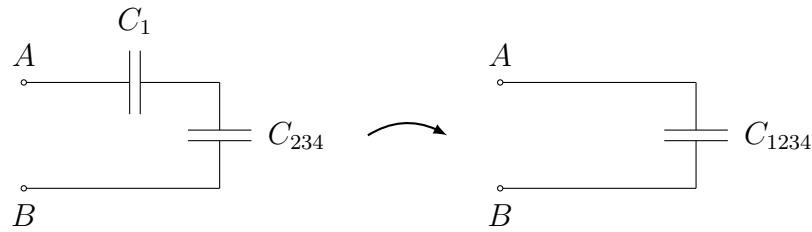
Comme la tension entre les points  $A$  et  $B$  est  $U_{AB} = 10 \text{ V}$ , la charge portée par cet ensemble de quatre condensateurs (équivalent au condensateur unique  $C_{1234}$ ) est donnée par
