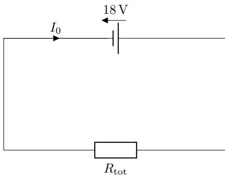
La tension aux bornes de  $R_{\text{tot}}$  est celle du générateur (loi des mailles) :
