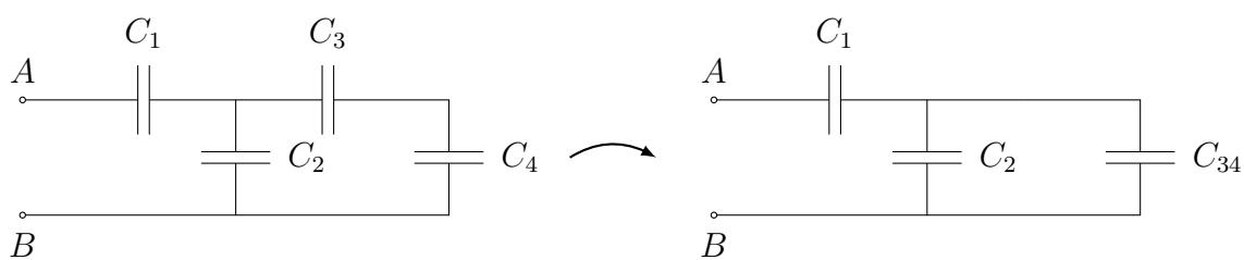
Les condensateurs  $C_2$  et  $C_{34}$  sont en parallèle. On peut donc les remplacer par un condensateur  $C_{234}$  de capacité (équivalente)
