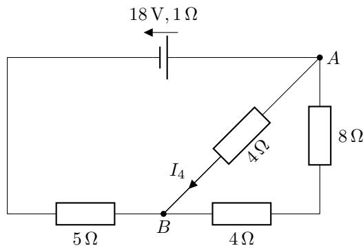
Le courant traversant la résistance supplémentaire de  $4\Omega$  est donné par la loi d'Ohm :
