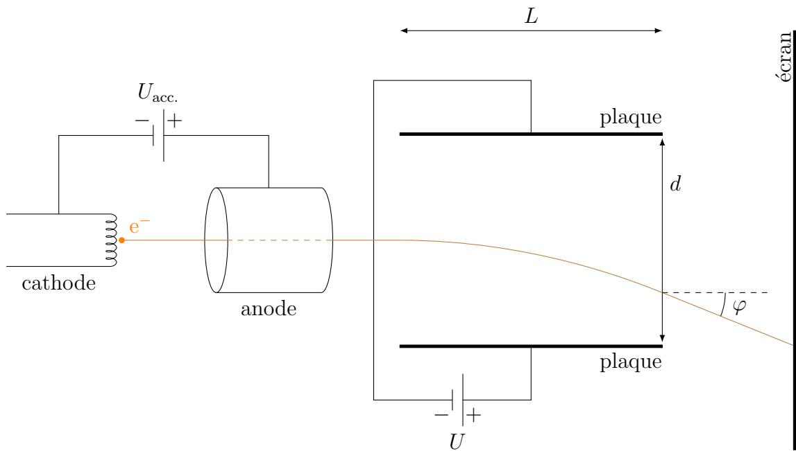
Un fil est chauffé suffisamment pour que des électrons puissent le quitter (à vitesse presque nulle). Ces électrons sont alors accélérés par la tension  $U_{\text{acc.}}$  puis défléchis par les plaques d'un condensateur plan (plaques de longueur  $L$  séparées d'une distance  $d$  et entre lesquelles règne une tension  $U$  à mesurer) pour finalement frapper un écran lumineux.
