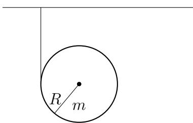
Un fil fixé à une poutre est enroulé autour d'un cylindre de rayon  $R$ , de masse  $m$  et de moment d'inertie  $I$  par rapport à son axe de symétrie. Départ arrêté, on laisse aller le cylindre.
