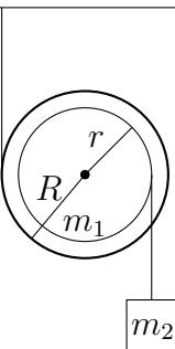
Un fil fixé à une poutre est enroulé autour d'un cylindre de rayon  $R$ , de masse  $m_1$  et de moment d'inertie  $I = \frac{1}{2}m_1R^2$  par rapport à son axe de symétrie. Un second fil attaché à une masse  $m_2$  est également enroulé sur le cylindre, mais à un rayon  $r = pR$ .
