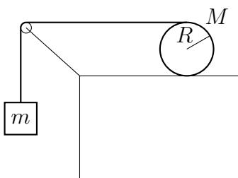
Un cylindre plein de masse  $M$  et de rayon  $R$  peut rouler sans glisser sur une table. Un fil enroulé sur le cylindre passe sur une petite poulie (de masse négligeable) et est fixé sur une masse  $m$ .
