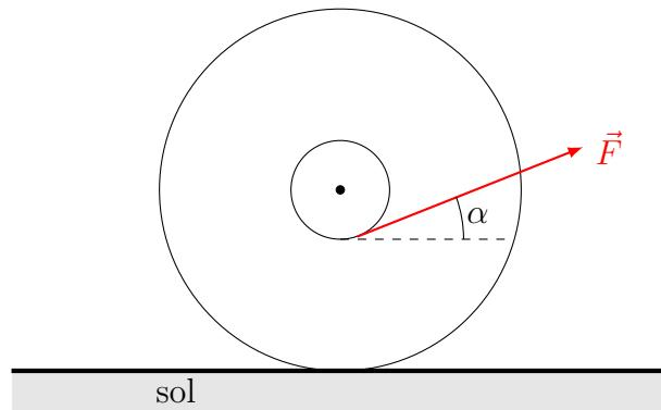
On note que le point de contact avec le support est plus éloigné du centre que le point de contact avec le fil.
