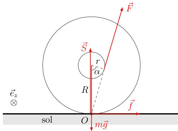
Le moment des forces  $\vec{S}$ ,  $m\vec{g}$  et  $\vec{f}$  est toujours nul par rapport à ce point. A l'équilibre, le moment de  $\vec{F}$  doit donc être nul, ce qui signifie que le support de  $\vec{F}$  (tangent au cylindre intérieur) passe par  $O$ , d'où  $\cos \alpha = \frac{r}{R}$ .
