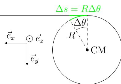
Si, pendant  $\Delta t$ , le cylindre tourne d'un angle  $\Delta\theta$  dans le sens donné par  $\vec{e}_z$ , le fil se déroule et le contrepoids se déplace de  $\Delta s = R\Delta\theta$  **par rapport au cylindre** dans le sens donné par  $\vec{e}_y$ . Comme le cylindre avance de  $\Delta x_M$ ,  $m$  se déplace de
