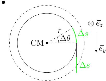
Si, pendant  $\Delta t$ , le cylindre tourne d'un angle  $\Delta\theta$  dans le sens donné par  $\vec{e}_z$ , le fil se déroule et le contrepoids se déplace de  $\Delta s = r\Delta\theta$  **par rapport au cylindre** dans le sens donné par  $\vec{e}_y$ .
