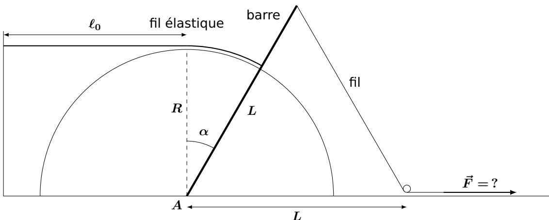
Avec quelle force  $\vec{F}$  doit-on tirer sur le second fil pour que l'angle entre la barre et la verticale soit égal à  $\alpha = \frac{\pi}{6}$ ? (On admet qu'une telle force est nécessaire.)
