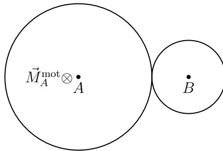
Deux roues vides (anneaux) sont montées sur des axes verticaux fixes  $A$  et  $B$ . Elles sont en contact de sorte à s'entraîner sans glisser l'une sur l'autre.
