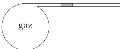
La goutte de mercure est à l'équilibre : les forces horizontales (ce sont des forces de pression) se compensent et alors  $p_{\text{gaz}} = p_a$  et
