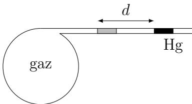
A nouveau, la goutte de mercure est à l'équilibre : les forces horizontales (ce sont des forces de pression) se compensent et alors  $p_{\text{gaz}} = p_a$ .Le volume du gaz a changé de  $Sd$  et la température de  $\Delta T$  :
