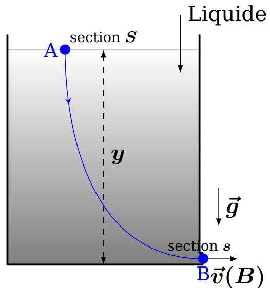
On suppose  $g$  constant le long du récipient et on suppose que l'eau est incompressible et parfaite, de sorte que sa densité est constante et qu'on peut négliger les effets de la viscosité. De plus, l'écoulement de l'eau sera stationnaire et  $S \gg s$ . Considérons un petit volume d'eau se déplaçant sur une ligne de courant (en bleu sur la figure). Le théorème de Bernouilli exprime alors la conservation de la densité d'énergie :
