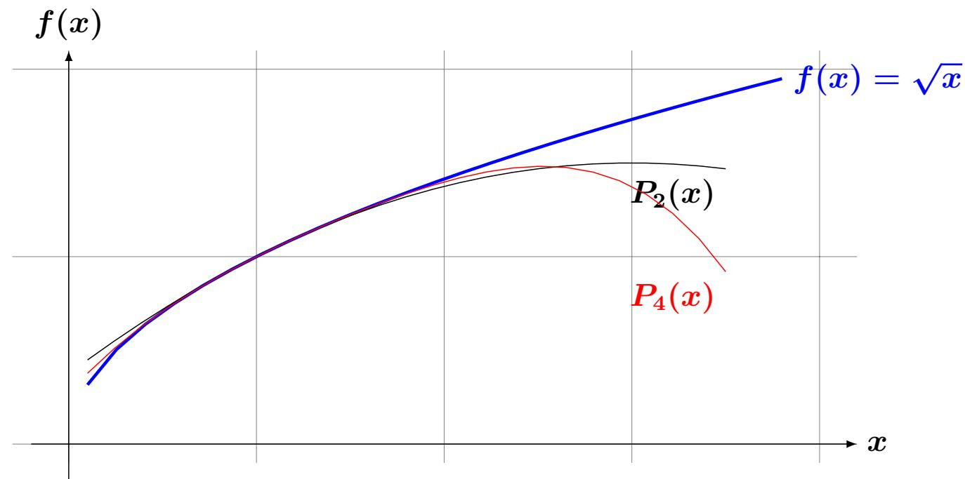
On constate que  $P_4(x)$  est une meilleure approximation de  $\sqrt{x}$  sur l'intervalle  $]0, 2[$  (pour  $x > 2$ , il semble se produire un "décrochage"). Testons avec l'approximation de  $\sqrt{2}$  par  $P_4$  :
