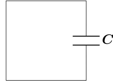
Le fil a une résistance de  $R$  Ohm et le condensateur une capacité de  $C$ . Supposons de plus une charge  $Q_0$  placée sur le condensateur à un temps initial  $t_0 = 0$ .
