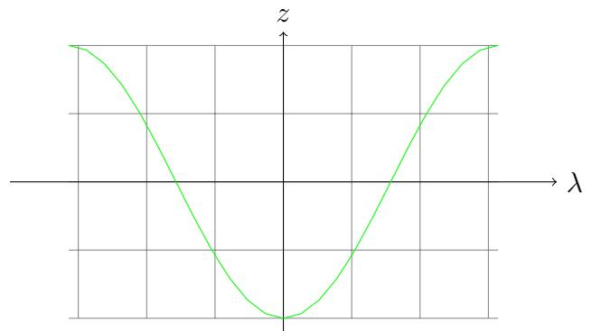
Soit un point  $P$  sur l'intersection du cylindre avec le plan incliné. Celui-ci aura comme coordonnées  $P(R \cos(\lambda), R \sin(\lambda), z_P)$ . La projection  $Q$  de ce point sur le plan  $(yOz)$  aura comme coordonnées  $Q(0, R \sin(\lambda), z_P)$ . Soit encore le point  $A(0, R \sin(\lambda), 0)$ . On a  $\widehat{QPA} = \alpha$ . On en conclut que
