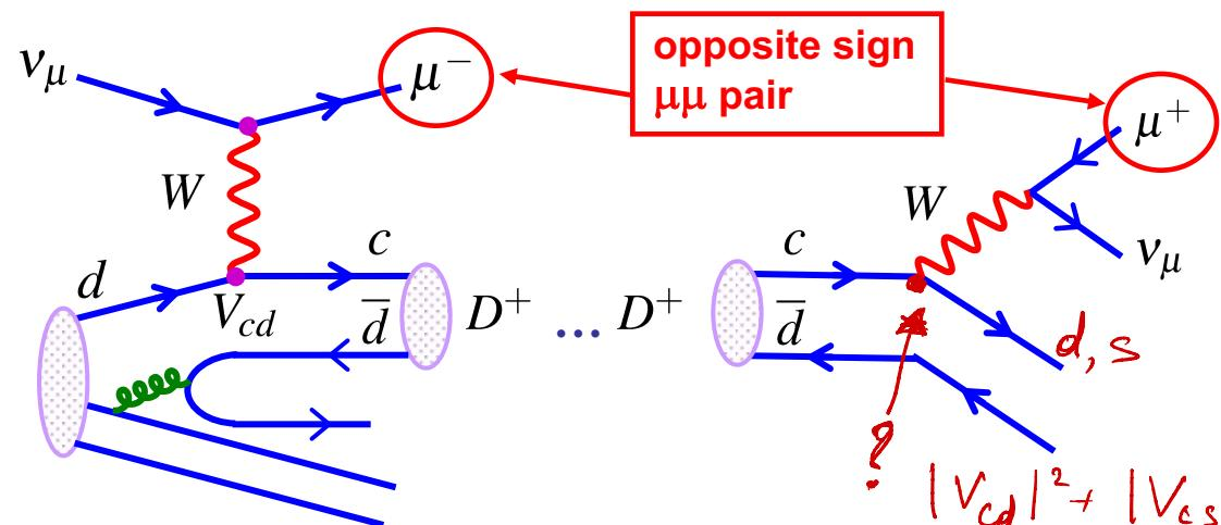
$$\text{Rate} \propto |V_{cd}|^2 \text{Br}(D^+ \rightarrow X \mu^+ \nu_\mu)$$
