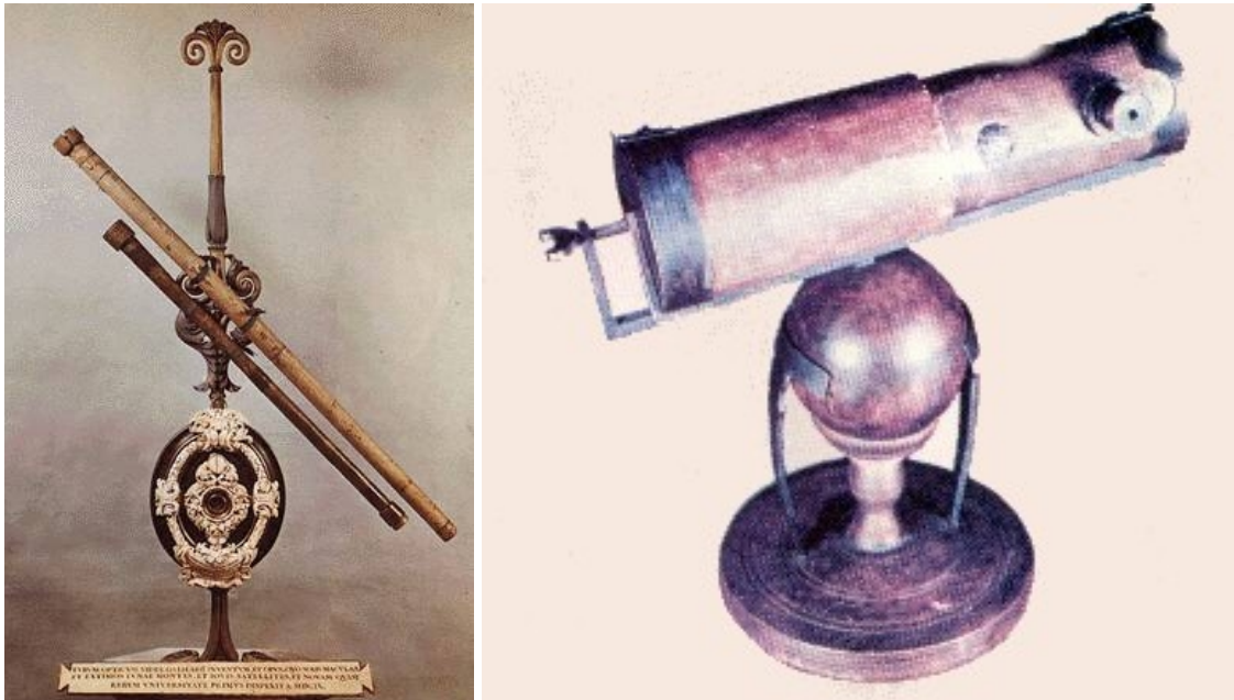
FIGURE 5.2 – La lunette de Galilée (1564-1642), à gauche, et le télescope à miroir, à droite, présenté par Newton en 1672 à la “Royal Society” de Londres. Les deux instruments ont un diamètre d’environ 4 cm.
