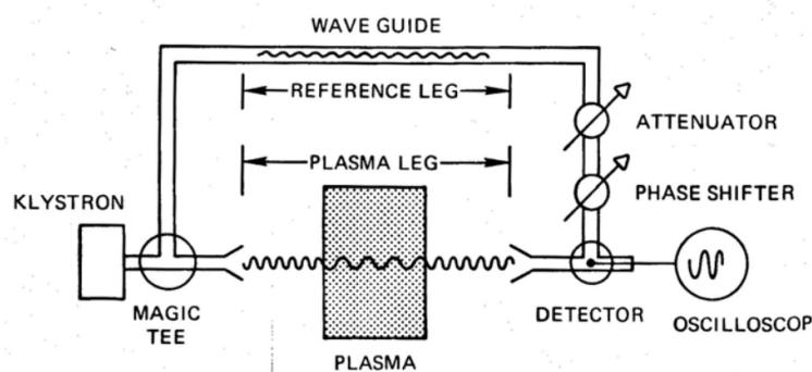
Exemple de montage expérimental utilisé pour mesurer la densité de plasma par interférométrie.
