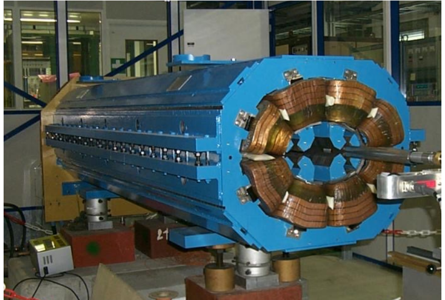
Double quadrupôle pour les 2 faisceaux du LHC
