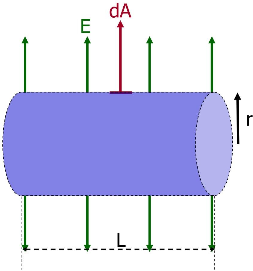
$$\vec{E} \cdot d\vec{A} = E dA \text{ because } \vec{E} \parallel d\vec{A}$$
