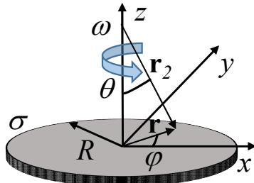
Le champ magnétique produit par le disque chargé en rotation est équivalent au champ magnétique produit par des spires concentriques circulaires.  $\mathbf{B}$  est dans la direction  $z$ :  $\mathbf{B}(0, 0, z) = B_z(0, 0, z)\hat{\mathbf{z}}$  (1 point)
