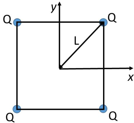
1. Déterminer le champ électrique  $\mathbf{E}$  à l'origine (i.e.,  $\mathbf{E}=(E_x(0,0,0), E_y(0,0,0), E_z(0,0,0))$ ) créé par les quatre charges ponctuelle en fonction des paramètres donnés ( $L, Q$ ). [0.5 points]
