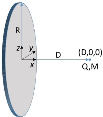
Un disque très mince de rayon  $R$  est chargé uniformément avec une densité de charge de surface  $\sigma > 0$  (en  $C/m^2$ ). Il est placé dans le plan  $yz$  avec son centre à l'origine  $(0,0,0)$ . Une très petite particule ayant une charge  $Q < 0$  et une masse  $M$  est aussi présente.
