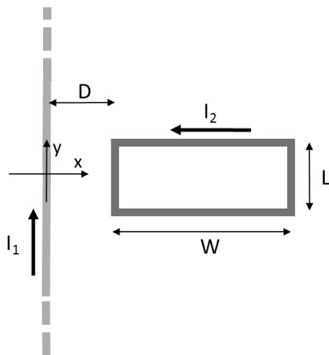
Une spire conductrice rectangulaire fermée (largeur  $W$ , hauteur  $L$ , résistance  $R$ , inductance négligeable) est placée à une distance  $D$  à côté d'un fil conducteur de longueur infinie (voir figure).
