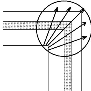
Ces situations se rencontrent dans les coins, les têtes de dalles et à chaque endroit où il y a une inhomogénéité dans l'épaisseur d'un élément du bâtiment. Ces endroits donnent lieu à ce que l'on appelle des ponts thermiques.
