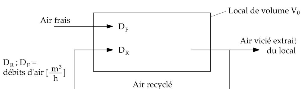
L'air « brassé » comporte une fraction d'air recyclé ainsi qu'une fraction d'air neuf (air de renouvellement).
