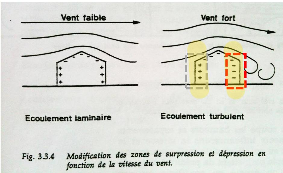
Surpression sur le flanc du bâtiment exposé au vent, ainsi qu'une dépression de l'autre côte.
