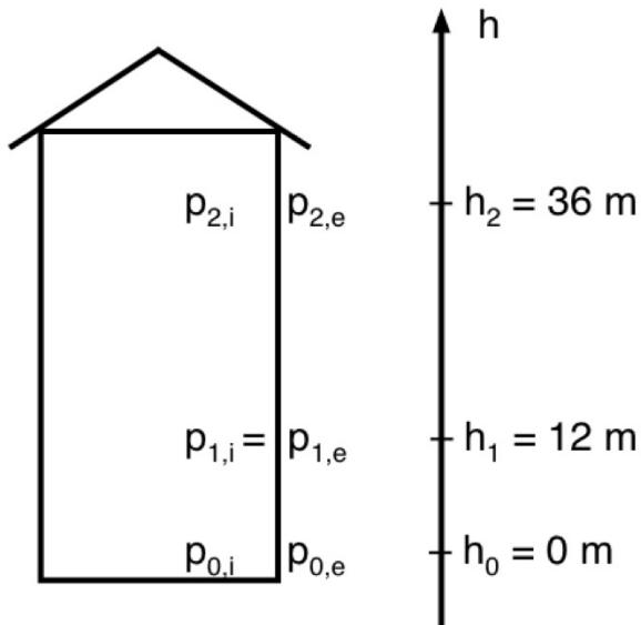
Il faut à présent calculer les pressions à l'intérieur et à l'extérieur en '0' et en '2', en fonction des pressions en '1'.
