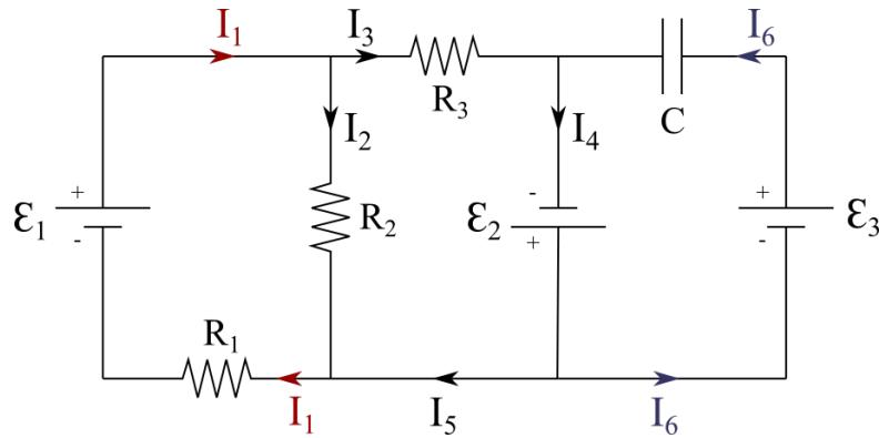
a) Lorsque l'état d'équilibre est atteint, la tension aux bornes du condensateur  $V_C$  est constante. Donc le courant à travers le condensateur est nul :  $I_6 = dV_C/dt = 0$ .
