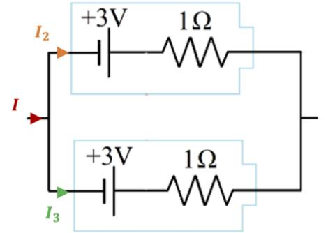
Cette combinaison de deux batteries en parallèle est équivalente à un bloc composé d'une source de tension de 3V et d'une résistance de 0.5 Ohm. En connectant les batteries en parallèle, nous avons donc réduit de moitié la résistance interne de la batterie résultante. Avec cette différence de résistance pour l'équation (20) on obtient :
