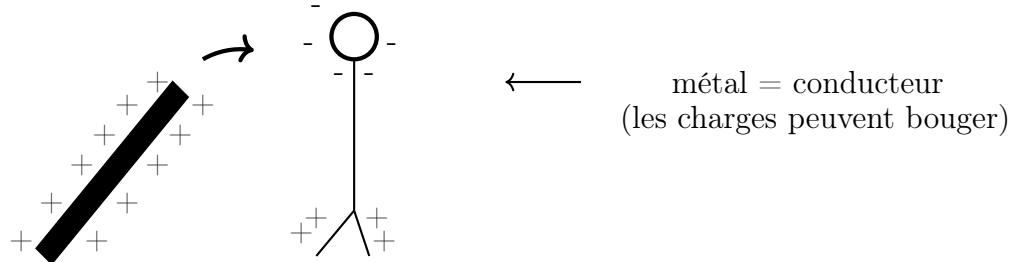
La force se manifeste sans contact ! L'électroscop reste neutre, mais les charges sont déplacées : c'est "induction" électrostatique [= "séparation de charge dans conducteur"]
