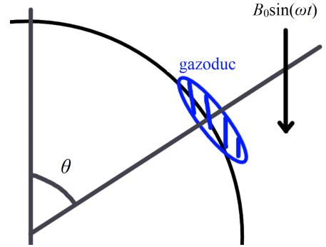
a) Pour trouver le champ électrique dans l'espace du tuyau, nous pouvons utiliser la loi de Faraday. Nous pouvons évaluer le changement de flux magnétique à travers la boucle de tuyau de la manière suivante :
