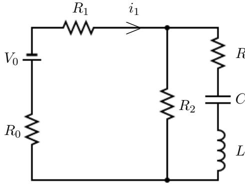
d) La tension à travers la résistance est :  $V_R(t) = V(t) - i_1(t)(R_1 + R_0)$  et donc donc  $V_R(t)$  et  $V(t)$  doivent être en phase.
