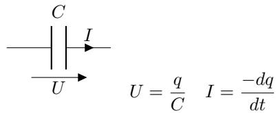
$$\text{Capacité équivalente en série : } C_{equil} = \left( \sum_i \frac{1}{C_i} \right)^{-1}$$
