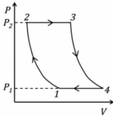
On considère une machine thermique, utilisant comme fluide un gaz parfait de coefficient adiabatique  $\gamma=1.4$ , qui fonctionne selon le cycle indiqué dans la figure ci-dessus. Les transformations de ce cycle, dit moteur de Joule ou cycle de Brayton, sont quasi-statiques et composées de deux
