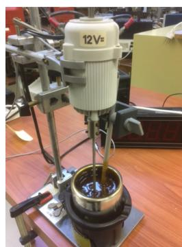
On donne la puissance à vide ( $U(V) \times I(A) = 10.8 \text{ W}$ ) et la capacité calorifique de l'ensemble ( $C = 137.28 \text{ cal}^{\circ}\text{C}$ ).
