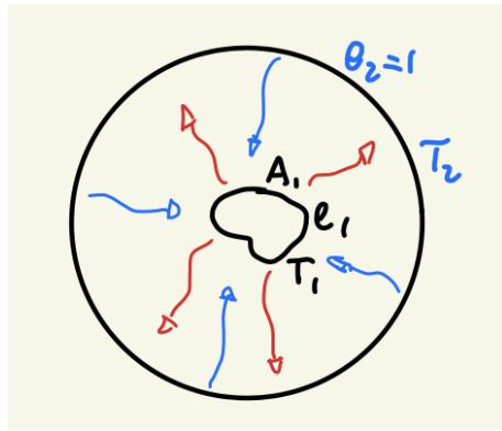
Le premier corps émet une puissance  $P_1 = e_1 \sigma_B T_1^4 A_1$  tandis que le deuxième émet  $P_2 = \text{const.} T_2^4$ . Quelle est la valeur de la constante ? Faisons le bilan d'énergie sur le corps 1 :
