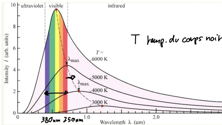
On observe que si  $T$  augmente, 1) le maximum de l'émittance est à une longueur d'onde plus courte et 2) l'émission totale  $\int_0^\infty \mathcal{E}_\lambda d\lambda$  augmente.
