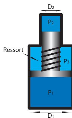
On considère que les volumes sont remplis de gaz parfait. Le ressort a une constante de  $k = 8000 \text{ N}\cdot\text{cm}^{-1}$ . Déterminer la compression ou l'allongement du ressort à l'équilibre en fonction des diamètres  $D_1$  et  $D_2$  ainsi que des pressions  $P_1$ ,  $P_2$  et  $P_3$ . On considère que le montage est posé à l'horizontale.
