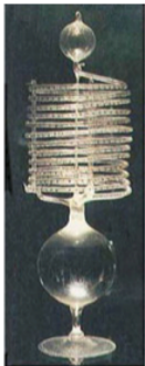
Thermomètre à dilatation de gaz Galilée 1592
